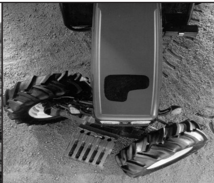
Serie TN. Los tractores doble tracción que giran más que los de simple tracción, hasta 76 grados
