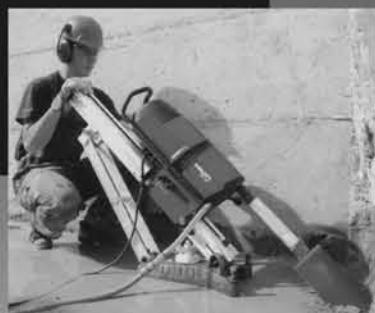
Máquina taladro-perforadora todos los diámetros
