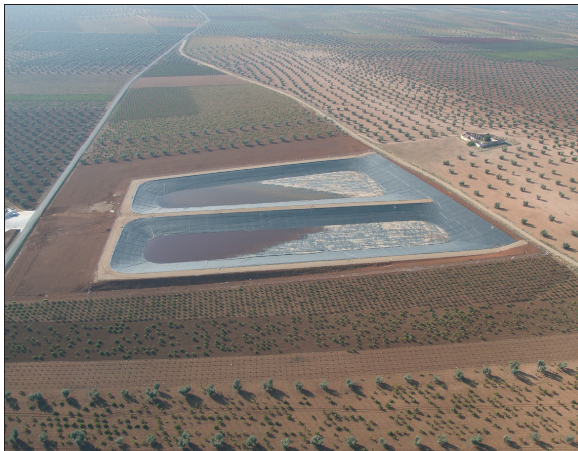
Balsas que permiten almacenar el líquido retante después de la extracción de los subproductos de la uva
