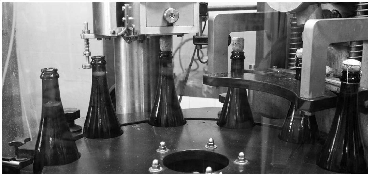
Máquina para poner los tapones de corcho a las botellas de cava en una de las bodegas de Almendralejo.
